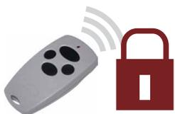
Система радиуправления использует технологию динамического кода, который изменяется при каждом сигнале, что обеспечивает полную безопасность и секретность производимого сигнала, исключая несанкционированное использование привода.
