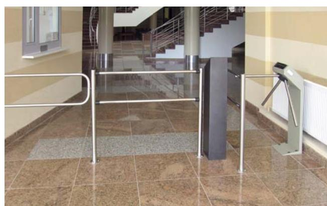
Формирование зон прохода с помощью полуростовых ограждений
