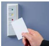
Снаружи помещения устанавливается контроллер со встроенным считывателем бесконтактных карт. Переключать режимы работы можно при помощи карты доступа или компьютера.
