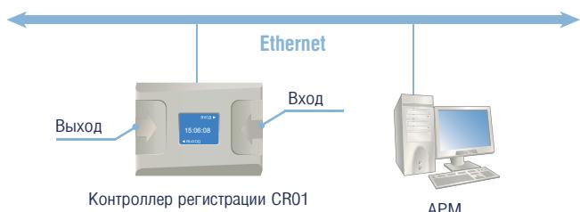
В контроллер CR01 встроены два считывателя бесконтактных карт для регистрации прихода и ухода сотрудников. Места для предъявления карт обозначены пиктограммами. Сотрудники получают бесконтактные карты доступа, которые предъявляют считывателям кон-
