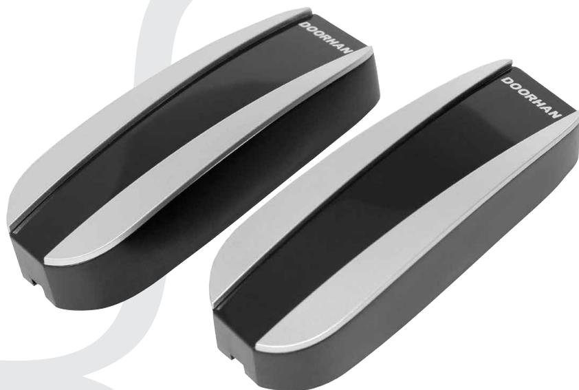
Фотоэлементы **PhotoCell-N** — устройство, состоящее из инфракрасного передатчика и приемника, которые устанавливаются в проем автоматизированных ворот для обеспечения максимальной безопасности их использования.
