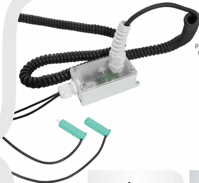
Оптико-электронные инфракрасные датчики (оптосенсоры) **Optokit** предназначены для обеспечения безопасности эксплуатации секционных ворот. Приемник и передатчик размещаются в нижнем резиновом профиле Rubber, при деформации которого прерывается оптический луч и подается сигнал блоку управления на остановку или реверс ворот.
